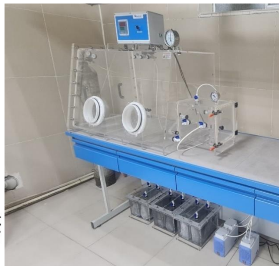
1-сурет – Жоғары таза Hg, Zn, Cu, In алу үшін тазарту және регенерациялау жүйесі бар герметикалық қорапты құрастыру және орнату схемасы;
